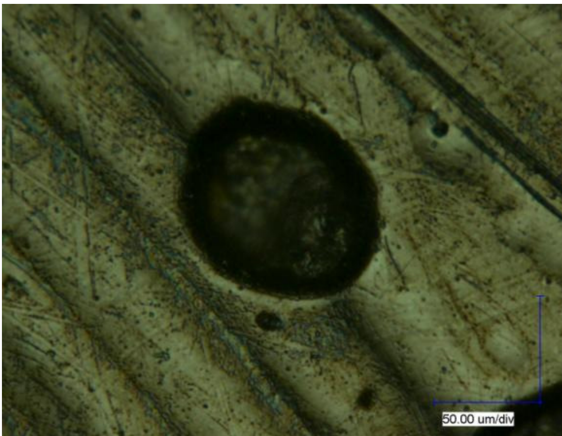
Bild 3 : Gieß-, Zieh- oder Hilfsmittel „düsen“ vom Zentrum der Pore aus dem Grundmaterial heraus.
