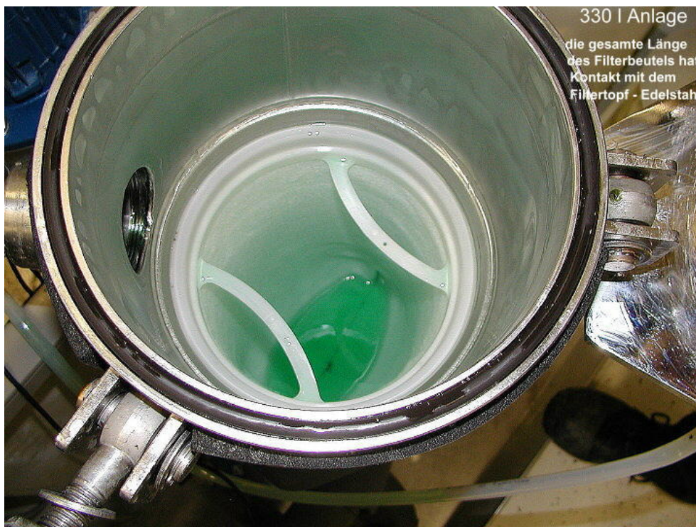
Bild 9: (a) Filtertopf mit Filterbeutel (Medienkontakt !)
