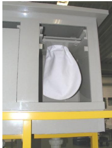
Bild 3: Freihängender Filterbeutel, zur Filterwartung geöffnet
