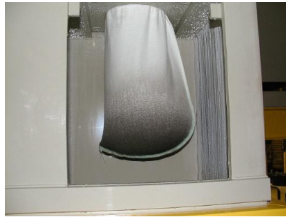
Bild 5: Freihängender Filterbeutel, mit Nickel- und Schmutzpartikeln gefüllt, jedoch ohne Medienkontakt
